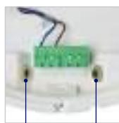
Einfache Weiterverdrahtung und Steckanschlussklemme
